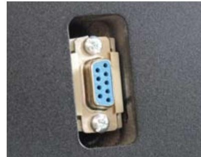
Über die RS-213-Schnittstelle empfängt der Motor die Signale vom Empfänger auf der Deckelplatte.
