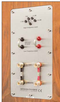
Das edle Anschlusspanel erlaubt Bi-Wiring. Sowohl Bass als auch Hochtון lassen sich durch Umsetzen der Brücken beeinflussen
