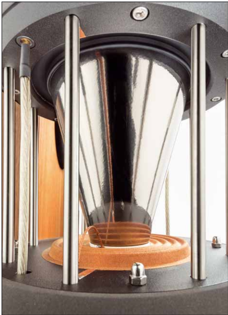
Der einzigartige Biegewellenkonus des DDD-Wandlers ist oben in einer speziell bedämpften Sicke gelagert. Unten befinden sich die Zentrierspinne und die 50-mm-Schwingspule
