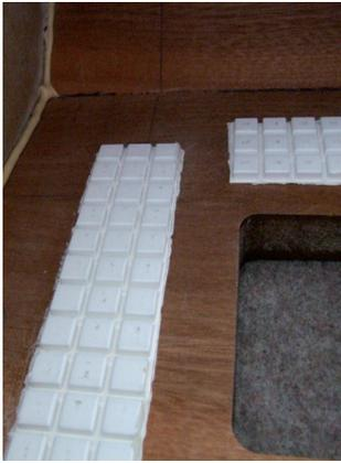
Exorbitante Wandstärken und Matten mit Füllungen aus Stahlschrot dämmen die Gehäuse und vermeiden Störschall.
